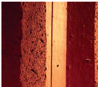
Рис. 6. Поризованная структура черепка
